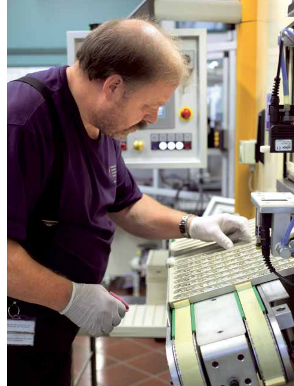
Walter Schmid ist bei der Herstellung von Sonder- und Jubiläumsmünzen mit dem Prägen der Enzianmünze beschäftigt.
