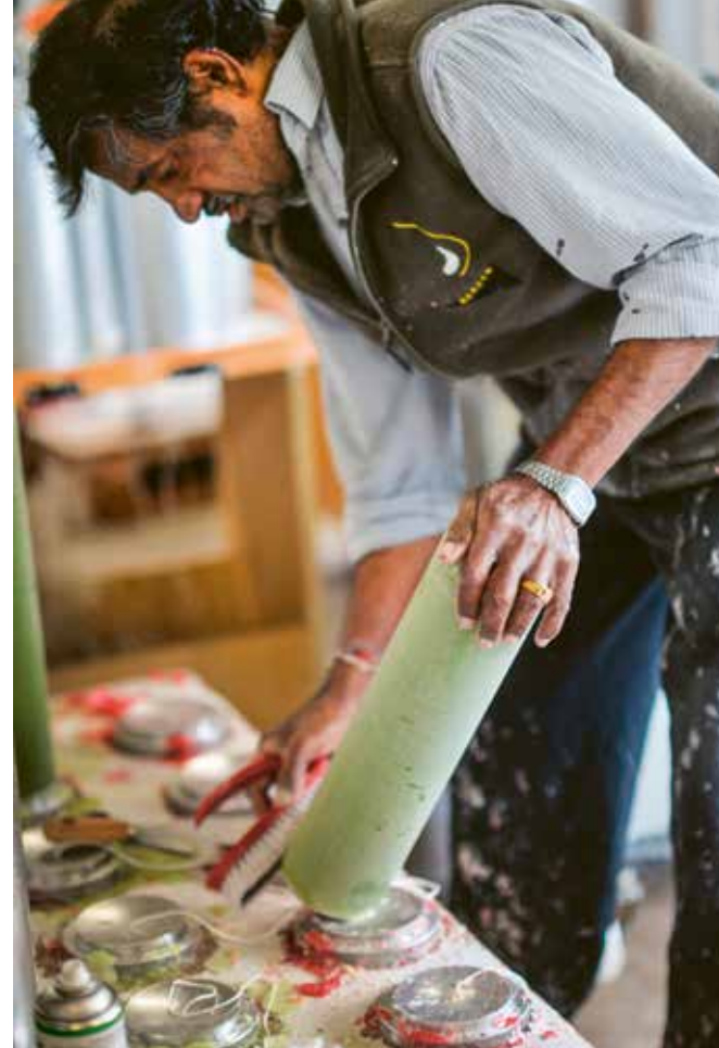
Direkt nach dem Abfüllen werden die Dochte eingemittet und fixiert (links oben); grössere Kerzen werden nach dem Herausholen aus den Formen mit der Bürste gereinigt (rechts oben). Das Kerzengiessen benötigt Platz, auch weil das Erkalten Zeit braucht (unten).
