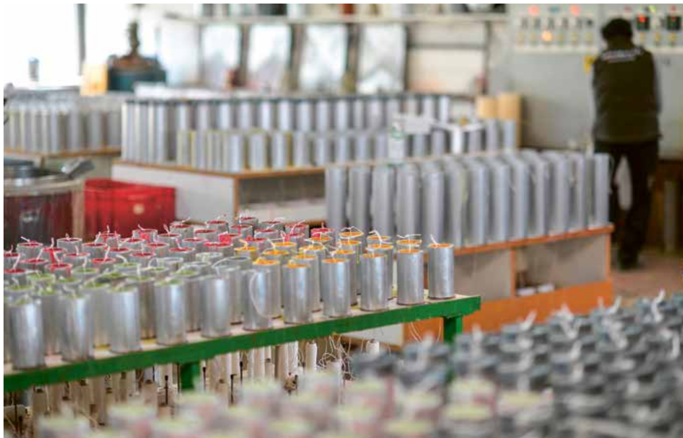
Direkt nach dem Abfüllen werden die Dochte eingemittet und fixiert (links oben); grössere Kerzen werden nach dem Herausholen aus den Formen mit der Bürste gereinigt (rechts oben). Das Kerzengiessen benötigt Platz, auch weil das Erkalten Zeit braucht (unten).
