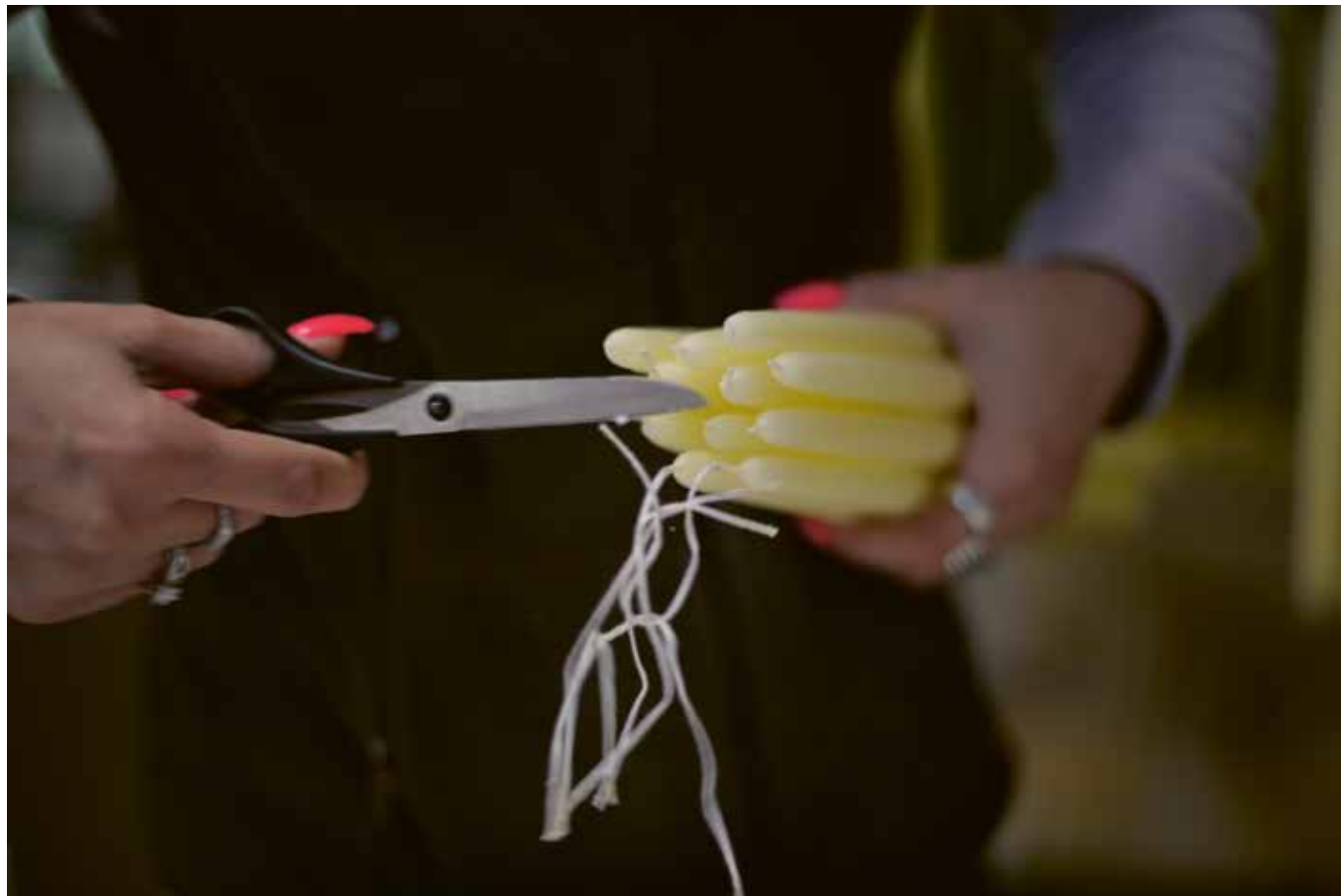
Viel Handarbeit: Zunächst wird das heisse Paraffin in die Formen gegossen (Bild oben). Bei den überzogenen Kerzen (Bild unten) werden die Dochte nach dem Erkalten der Kerzen zurechtgestutzt.
