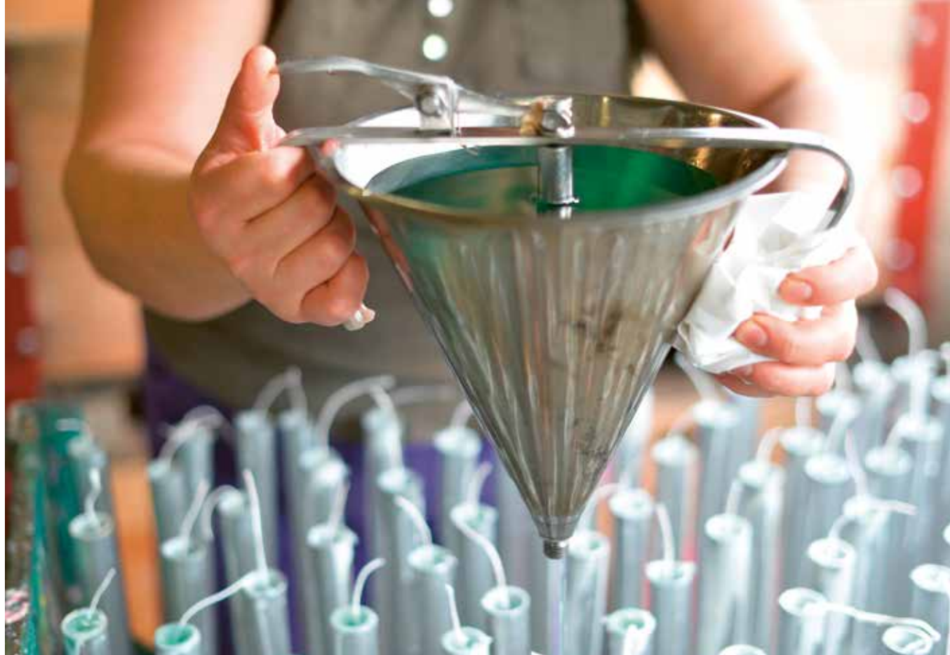
Viel Handarbeit: Zunächst wird das heisse Paraffin in die Formen gegossen (Bild oben). Bei den überzogenen Kerzen (Bild unten) werden die Dochte nach dem Erkalten der Kerzen zurechtgestutzt.
